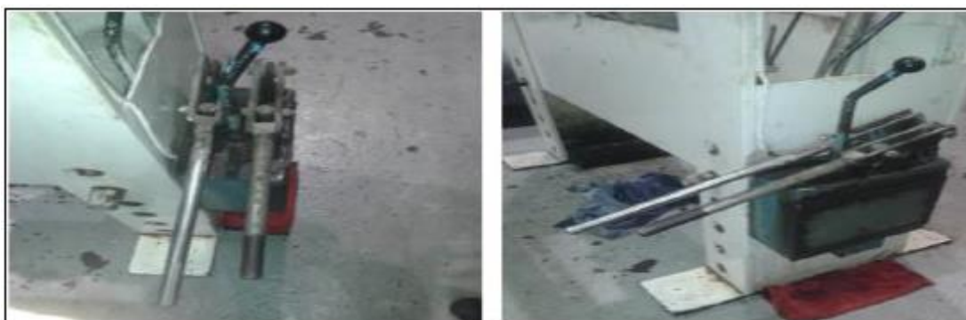
Figura 2. Palancas para ejercer presión manual a la máquina. Fuente: (Peña & Betancourt, 2016)
