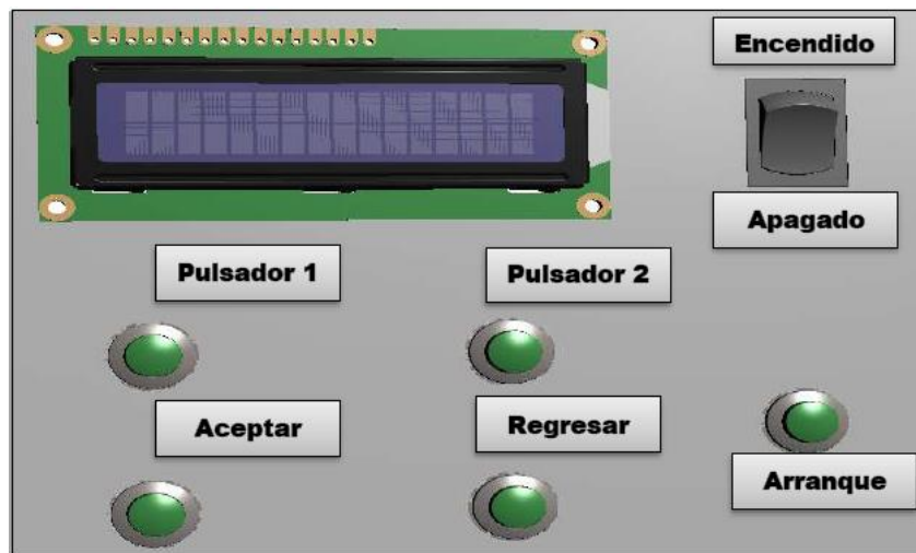
Figura 14. Presentación del panel HMI de la extrusora de piezas de arcilla. Fuente: (Arroyo, 2016)
