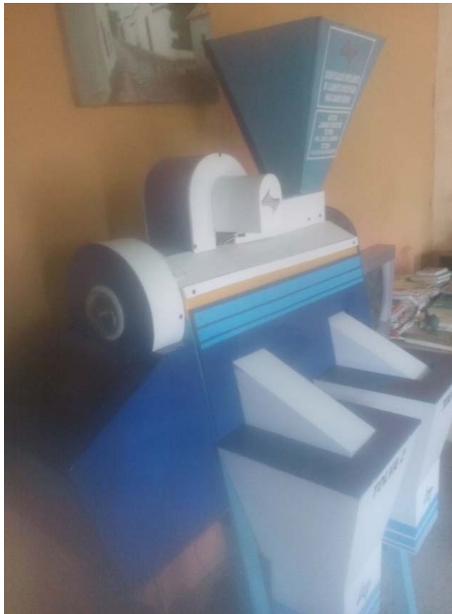
Figura 18. Equipo automatizado de dosificación de alimento concentrado para ganado bovino. Fuente: (Briceño, 2017)
