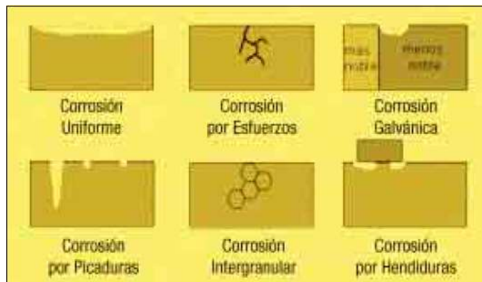
Figura 4. Algunos de los tipos de corrosión más comunes por influencia del medio, la estructura y composición del material. Fuente: (Cortés & Ortiz, 2004)
